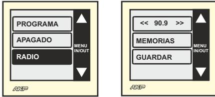
A central 0107xx dispõe de um sintonizador de rádio FM para fornecer audio a um canal da instalação, este sintonizador pode ser controlado desde o ecrã da central 0107xx ou desde um comando da instalação, se este dispõe do controlo das fontes musicais remotas (ver manual do comando).
