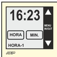
A central permite configurar a hora que se mostra em todos os comandos da instalação, por isto em caso de alterações da hora, terá de realizar a operação a partir deste módulo.
